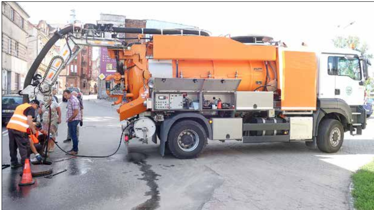
Specjalistyczny pojazd posiada system odzysku (recykling) wody
